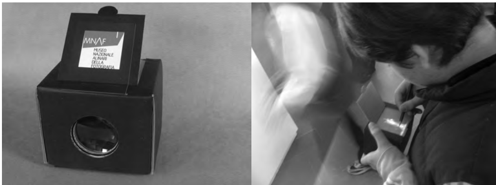
Abbildung 8 und 9: Zeichenkamera. Linse und Umkehrspiegel erzeugen auf einer Mattscheibe ein aufrechtes und seitenverkehrtes Bild. Auf der Mattscheibe liegt ein Transparentpapier, auf diesem wird gezeichnet. Museo Nazionale Fratelli Alinari, Florenz, 2008.
